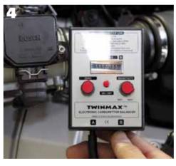
Den Twinmax über den rechten Drehrealer »einnullen«. Motor starten und auf Betriebstemperatur bringen. Überprüfen, ob der Motor bei Leerlaufdrehzahl (hier ca. 1000 bis 1150/min) synchron läuft. sprich die Anzeige beim Twinmax auf der Null steht.
