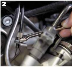
Als Zweites sollten die Gaszüge eingestellt werden, um sicherzuaehen. dass die Drosselklappen komplett schließen und nicht hängen. Beim 4-V-Boxer sind die Gaszüge oben an der Lenkerarmatur und unten, auf Höhe der Einspritzdüse zu lockern.
