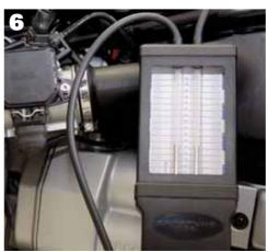
Motordrehzahl leicht erhöhen (2500/min) und auch hier den Synchronlauf der beiden Zvlinder überprüfen. Beim Carbtune sollten die Balken sich auf einem Niveau aufund abbewegen. Gegebenenfalls nochmals angleichen.
