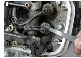
Die Basis einer perfekten Synchronisation: Nur ein korrekt eingestelltes Ventilspiel sorgt unterm Strich dafür. dass der Motor nach Abschluss aller Arbeiten richtig schön rund läuft. Also Ventildeckel runter. Ventillehre raus und das Ventilspiel bei kaltem Motor zwischen Kipphebel und Ventil laut Herstellerangaben einstellen. Außerdem Zündkerzen und Luftfilter checken und gegebenenfalls
