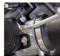
Leerlaufdrehzahl jetzt über Umluftschrauben einstellen. Durch Drehen der Schraube nach rechts oder links wird der Gleichlauf der einzelnen Zylinder eingestellt. Gleichzeitig darauf achten, dass die voraeschriebene Drehzahl eingehalten wird.
