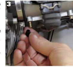
Jetzt den Synchrontester anschließen. Dazu die Verschlusskappen der Unterdruckstutzen an der Einspritzanlage (Vergaser) abziehen und die Schläuche des Synchrontesters anschließen Evtl. mitgelieferte Anschlussnippel verwenden.
